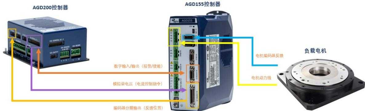
图 2.2.1-1 AGD200/AGC300+AGD155 模拟电流控制系统框图（图示为 AGD200）
