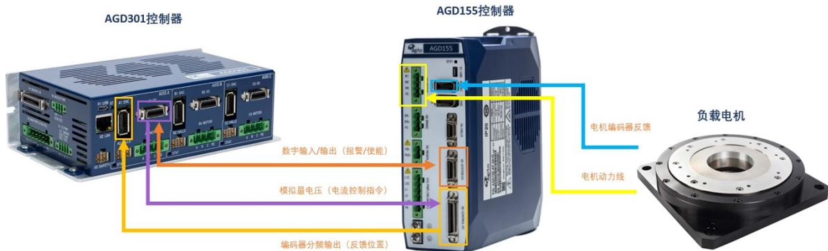
图 2.1.1 AGD301/AGC301+AGD155 系统框图（图示以 AGD301 为示例）
